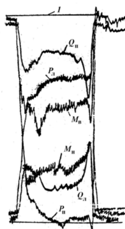
Рис. 2. Типичная осциллограмма моментов и усилий прокатки
